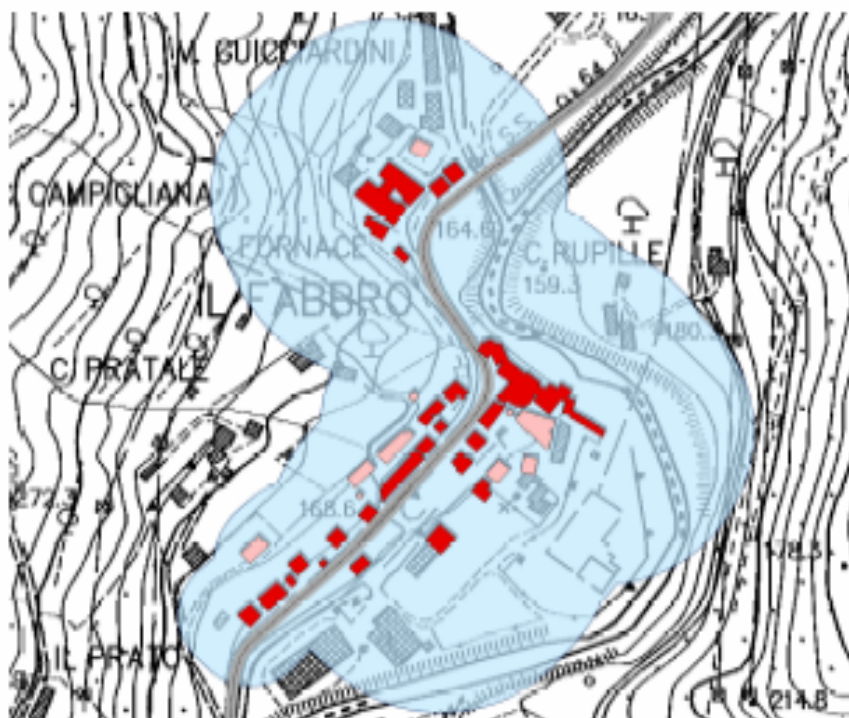
Figura 3: Tratto di sorgente critica e relativa area critica di una infrastruttura di trasporto stradale. In rosso i fabbricati con superamento dei limiti.
