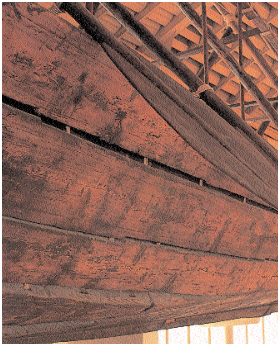
Particolare del sistema di unione delle assi della barca solare di Cheope, con le tavole raccordate da corde passanti per fori nello spessore del fasciame e nell'interno dell'imbarcazione, visibili nelle commessure allargate - Cairo, Museo della Barca Solare
