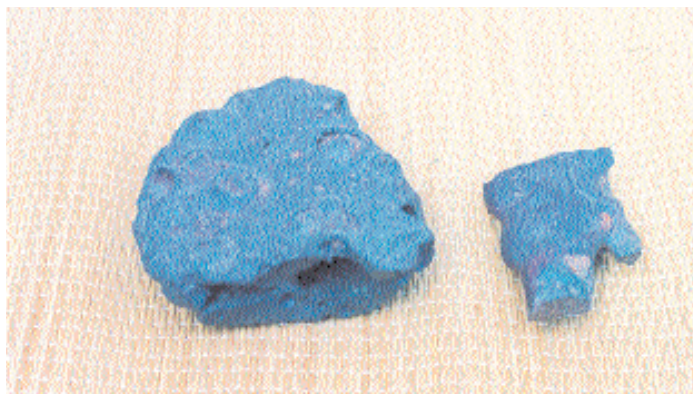
Alcune scorie di fusione del ferro dal golfo di Baratti a Populonia, sulle quali si riconoscono ancora le tracce dell'ebollizione del metallo -a sinistra- e del suo percolamento da liquefatto -a destra-
