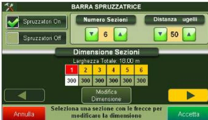
Si imposta sul navigatore la barra con il numero di sezioni e di spruzzatori per ogni sezione.
