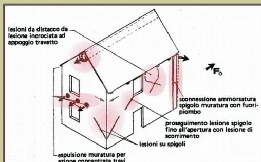
Il **danno** agli edifici è la conseguenza delle azioni sismiche prodotte da un terremoto su uno o più elementi strutturali. Le lesioni si formano secondo precisi “**meccanismi**” che dipendono dalla tipologia strutturale del singolo edificio e dalle caratteristiche del terremoto.
