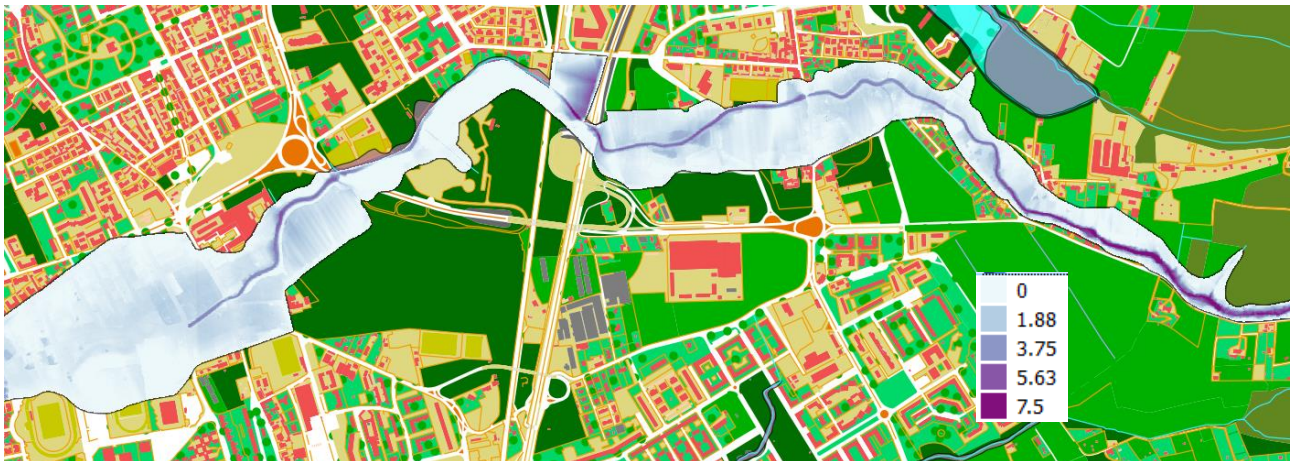
Figura 13 - Ricostruzione geomorfologica della superficie di inviluppo degli allagamenti del 10/9/17.
