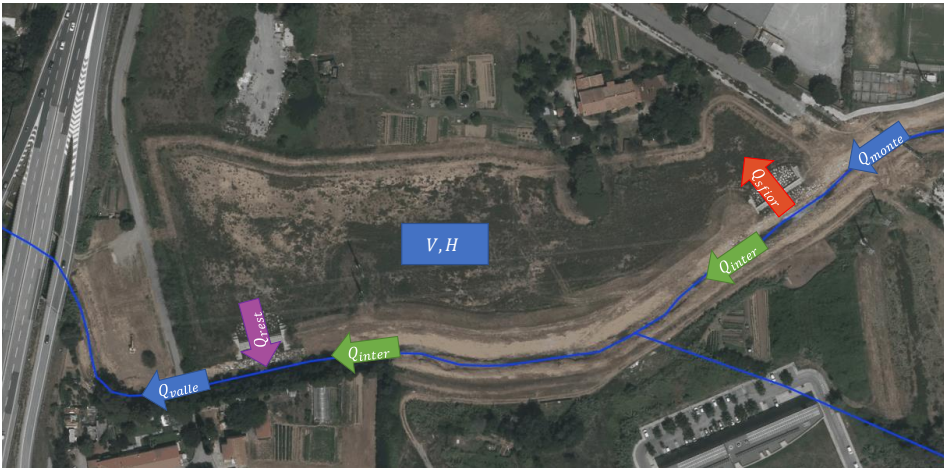
Figura 15 - Schema di riferimento per la simulazione in MOBIDIC delle casse d'espansione.
