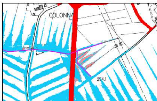
Figura 8.37 – modifica del rischio idraulico lungo il Fosso Colonna, in rosso il rilevato stradale, in celeste le aree allagate per Tr200 anni allo stato attuale, in rosa le ree allagate per Tr200 anni allo stato di progetto.
