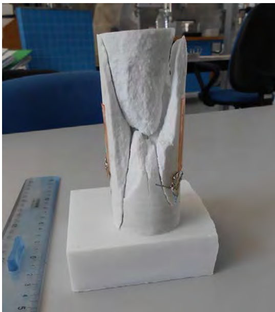
Figura 13 - Immagine del provino a termine della prova utilizzato per il test di compressione uniassiale e la misura della deformazione.
