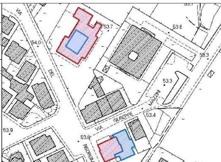
E' la porzione elementare di edificato avente altezza omogenea (all'interno della tolleranza di acquisizione), con base a terra. E' presente l'unità volumetrica anche nel caso del portico, mentre non fanno parte di questa classe i corpi aggettanti, per i quali si utilizza una classe specifica.
