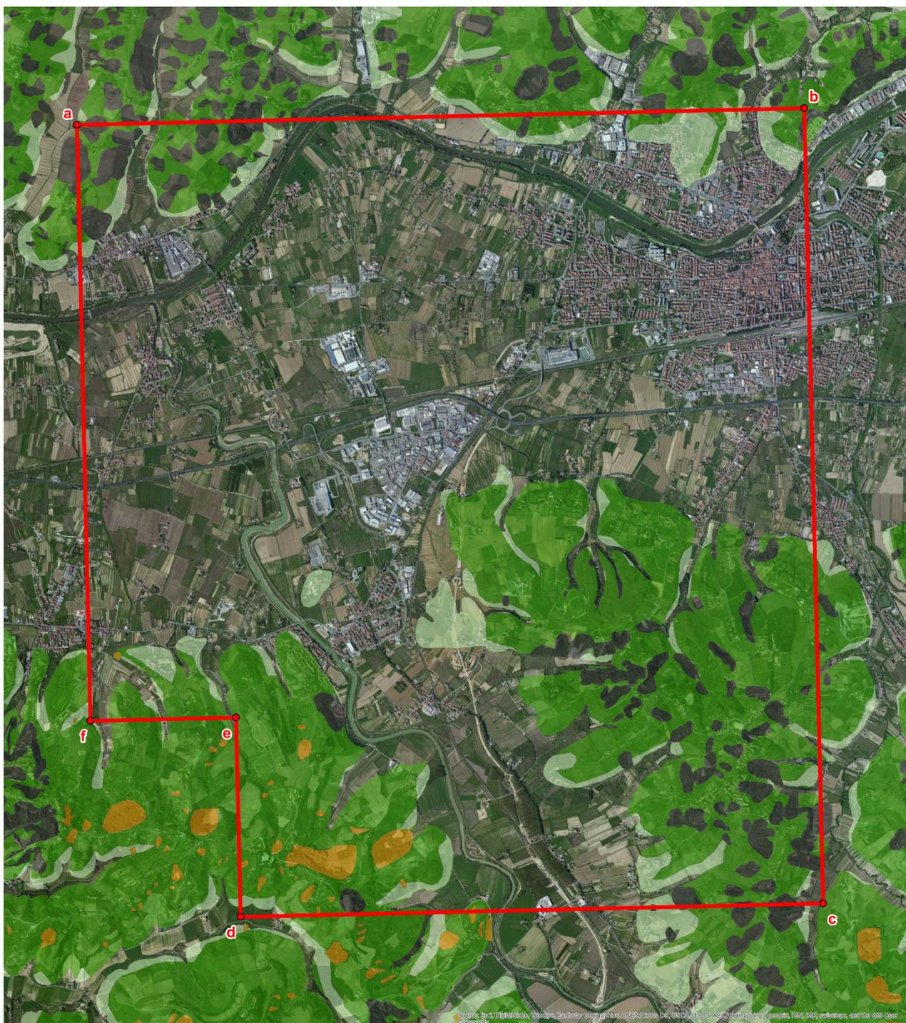
Figura 15 – Estratto Carta della Pericolosità da frana e da fenomeni geomorfologici di versante del vigente PAI – Livello di sintesi – scala 1:25.000 (fonte:Autorità di Bacino del fiume Arno)- verde chiaro P.F.1, verde scuro P.F.2, arancione P.F.3, grigio aree sviluppate con dettaglio a scala 1:10.000
