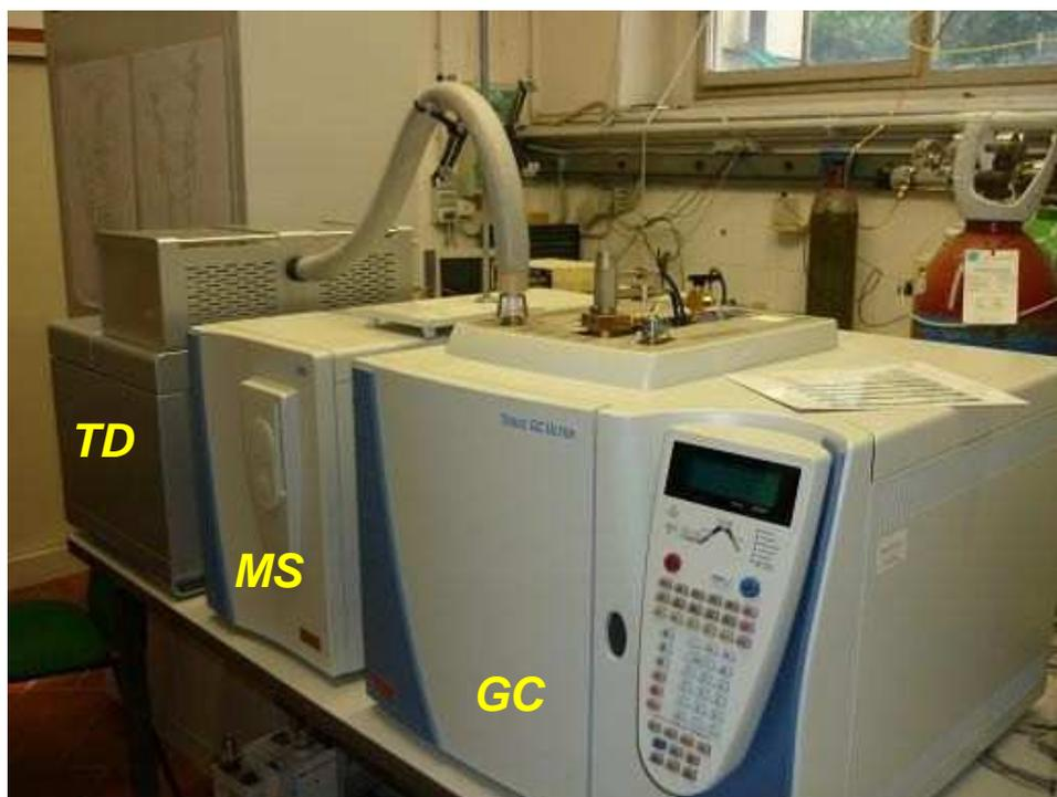
Figura 2.9 - GC-MS Thermo Trace GC Ultra accoppiato con desorbitore termico DANI Master TD e rivelatore a spettrometro quadrupolare Thermo DSQ.
