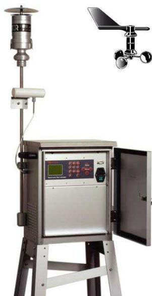
Figura 2.3 - Campionatore per particolato atmosferico TECORA (ECHO PM Ambient Sampler) con testa LVS PM10 2.3 m<sup>3</sup>/h.
