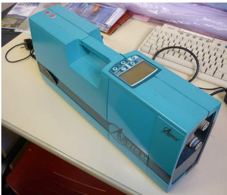
Figura 2.14 - Analizzatore mercurio gassoso LUMEX RA915 M.
