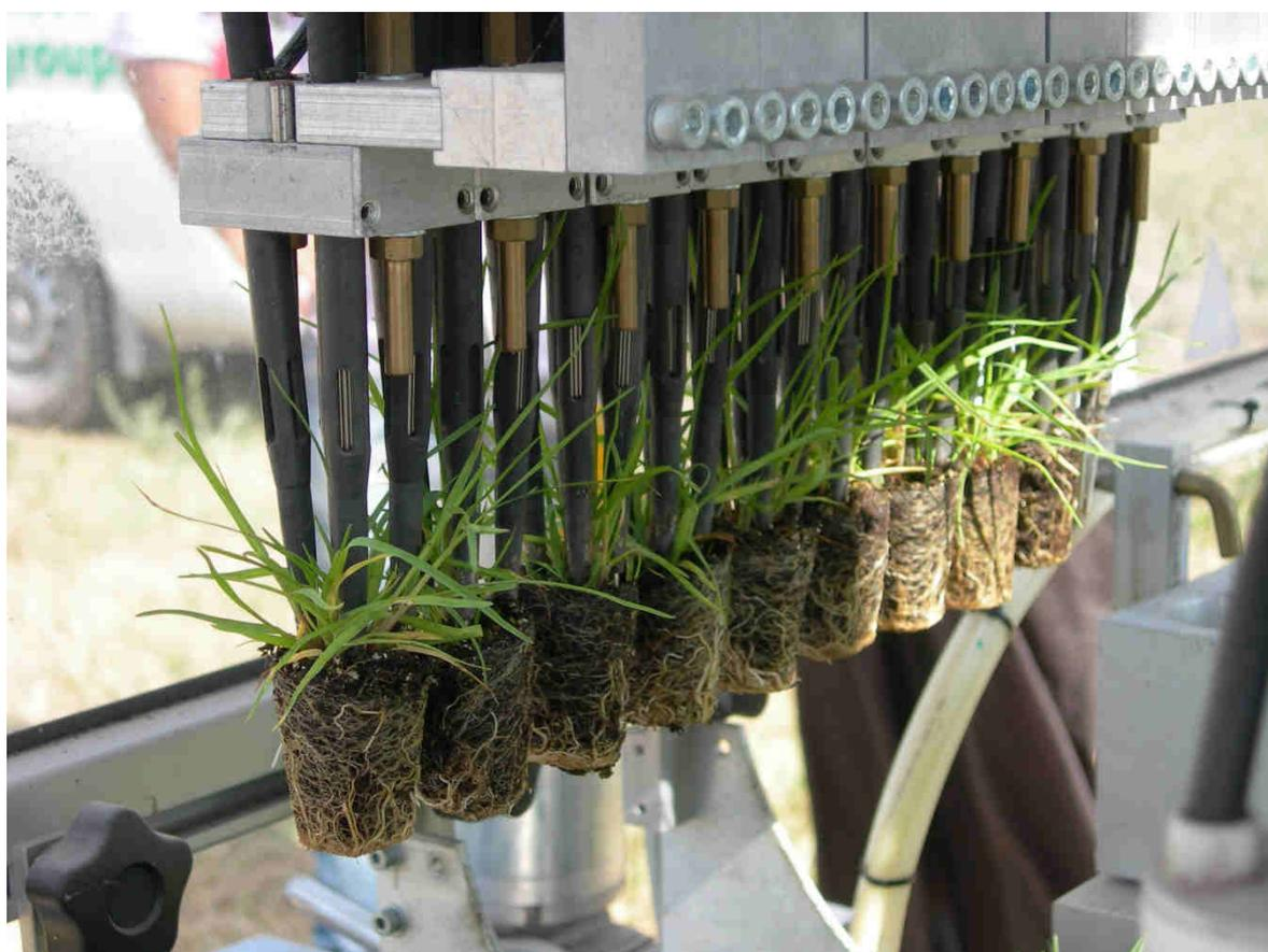
Figura 2 – Dispositivo per l'estrazione delle piantine dai vassoi alveolati.
