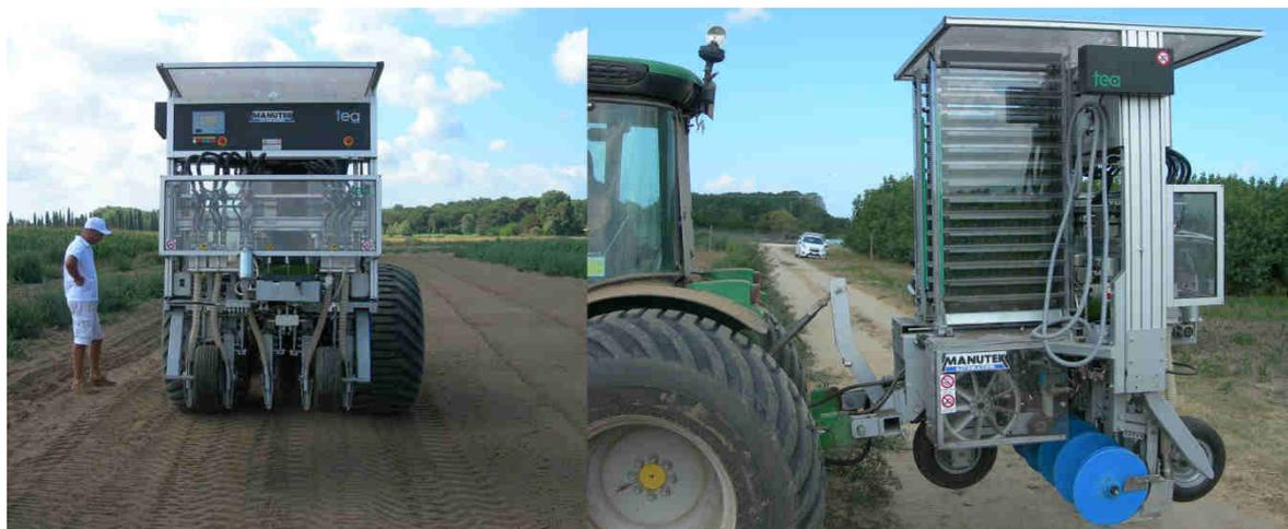
Figura 1 – Prototipo di trapiantatrice automatica per essenze da tappeto erboso allevate in vassoi alveolati realizzata nell'ambito del progetto SiTEE.
