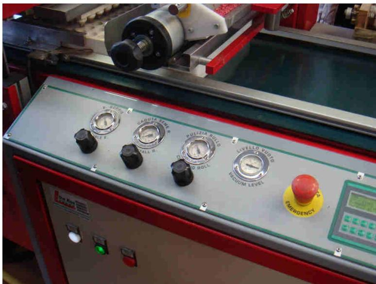
Figura 10. Macchina di semina a banco: dettaglio dei comandi che consentono la regolazione di alcuni parametri del processo di semina.
