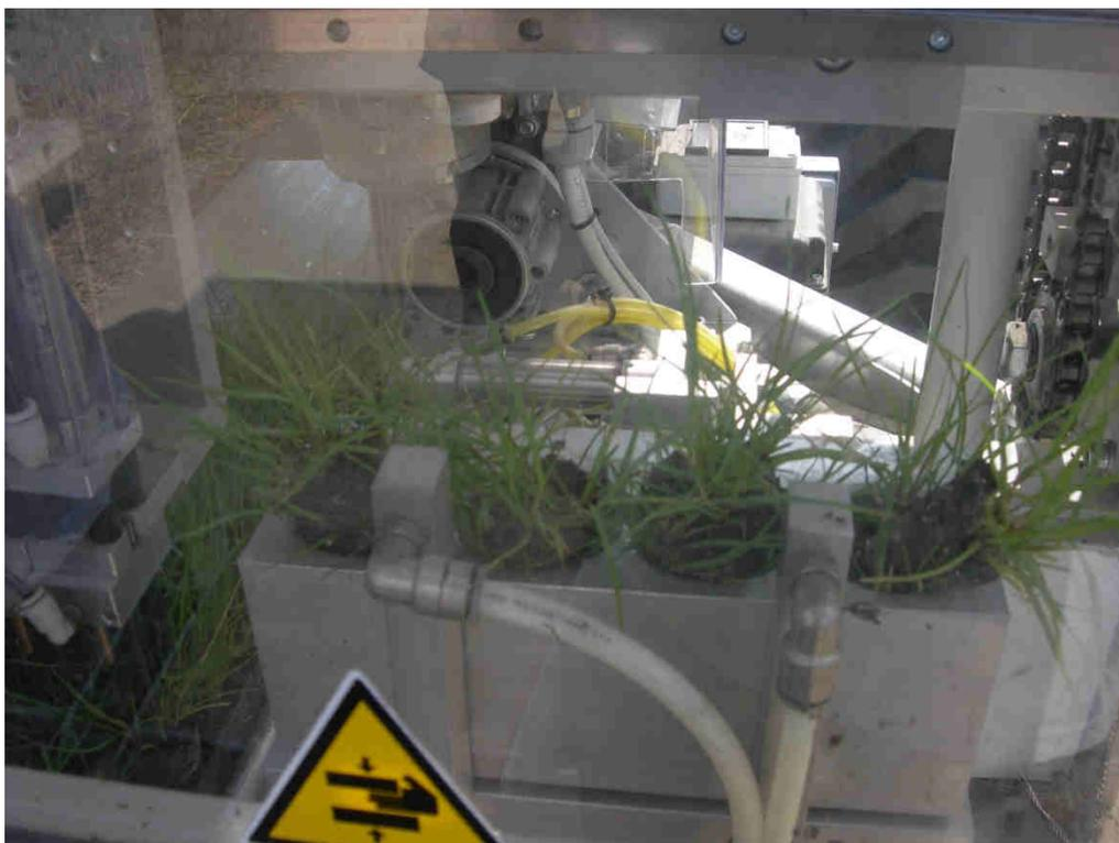
Figura 3 – Sistema a slitta per il convogliamento delle piantine estratte verso i tubi adduttori
