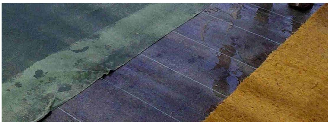
Figura 2. Telo verde in polipropilene (in alto a sinistra) e telo di cocco (in basso a destra)
