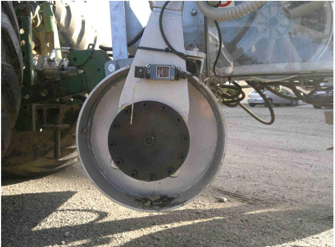
Figura 8 - Disco dotato di perni utilizzato nel dispositivo per ottenere la sincronizzazione del sistema di estrazione e prelievo delle piante con la velocità di avanzamento della macchina.
