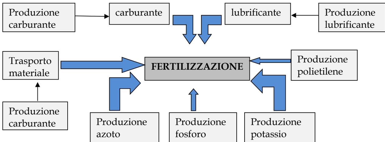
Fig. 3.5.9 - Flow chart del processo di produzione della fertilizzazione
