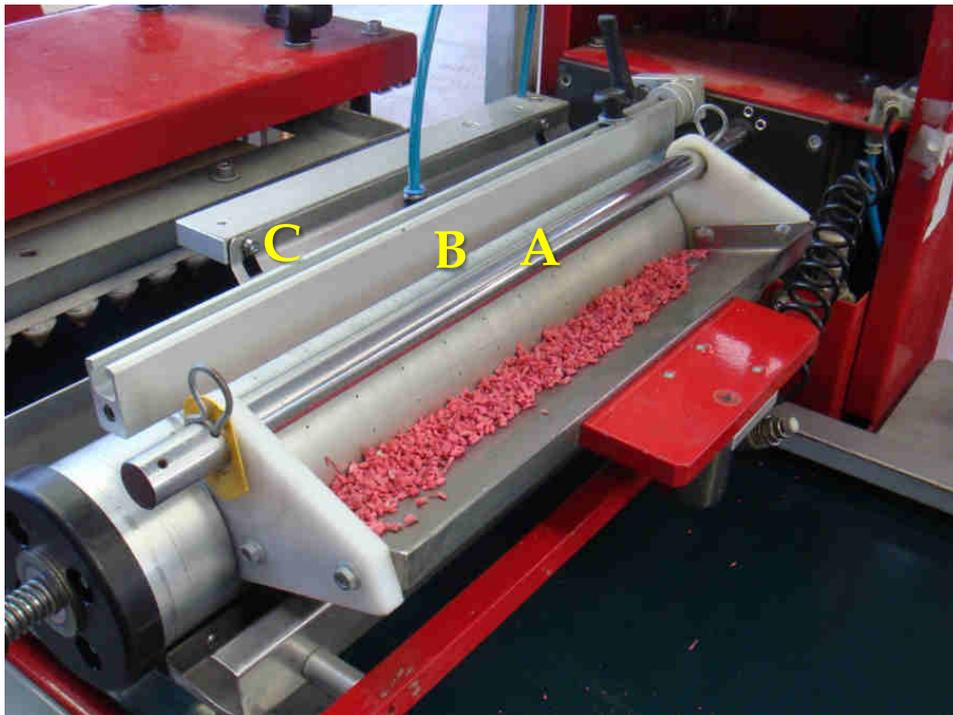
Figura 9. Macchina di semina a banco: dettaglio dell'unità di prelievo del seme. Si possono notare il cassetto di alimentazione (A), il rullo distributore (B) e la barra di pulizia del rullo (C).
