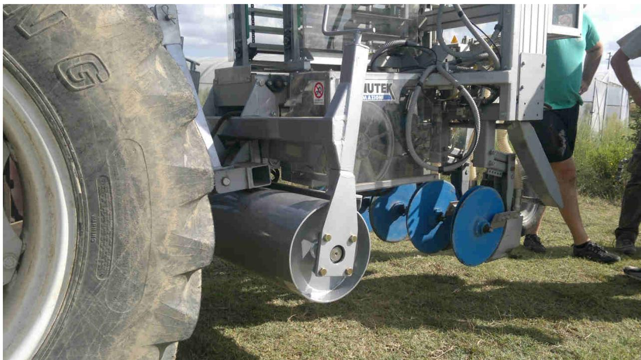
Figura 7 - La ruota di appoggio anteriore è stata sostituita con un rullo metallico provvisto di martinetti manuali.
