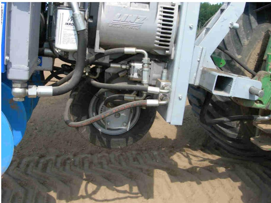
Figura 6 - Ruota pneumatica anteriore della trapiantatrice sui cui è installato il dispositivo per il rilevamento della velocità di avanzamento.
