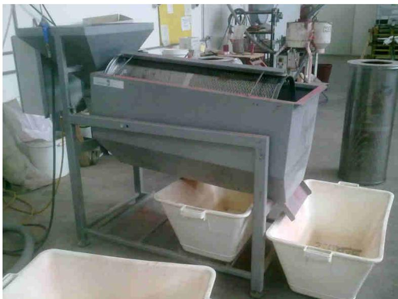
Figura 4. Vaglio a tamburo rotante utilizzato per separare le frazioni di dimensioni diverse.
