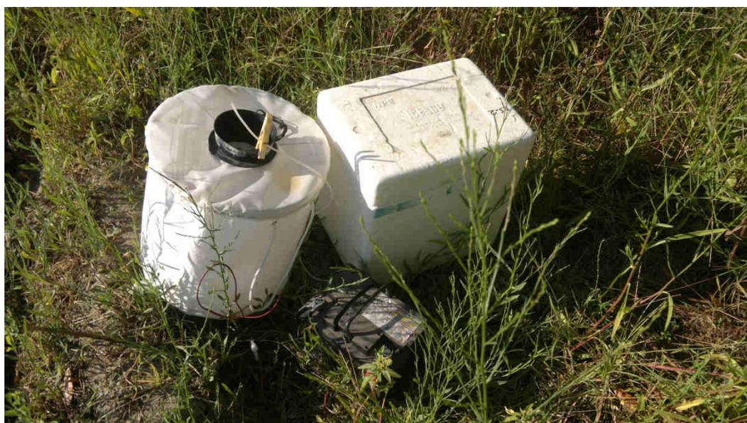
Fig. 3 - Trappola BG-Sentinel con contenitore di polistirolo per il mantenimento della carica di anidride carbonica solida.
