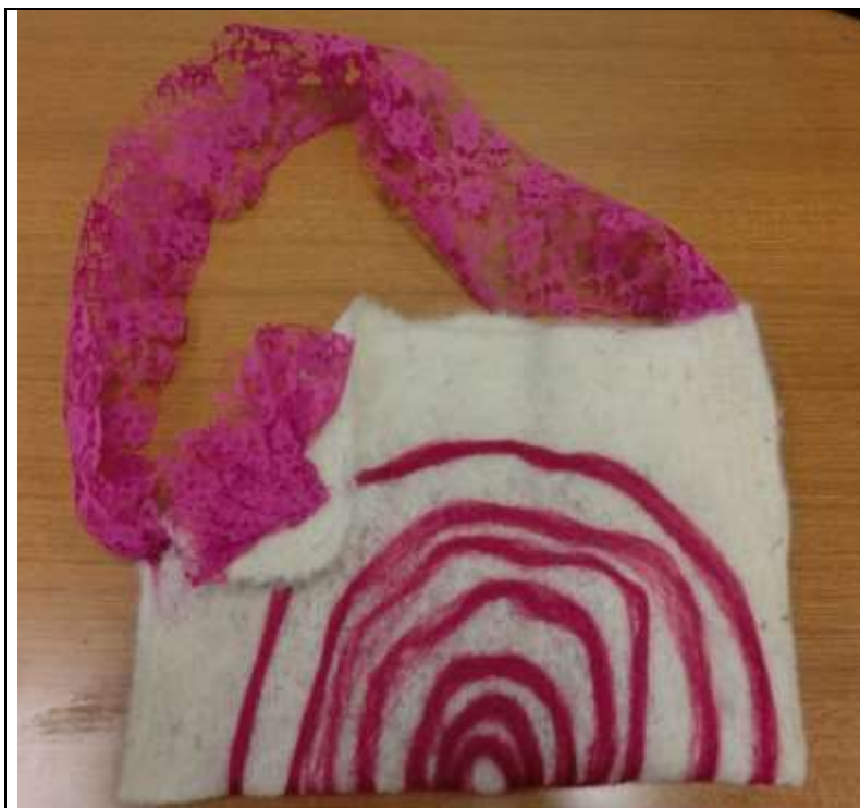
Campione realizzato con agugliatrice manuale: prototipo di borsa realizzato con tessuto non tessuto e tulle
