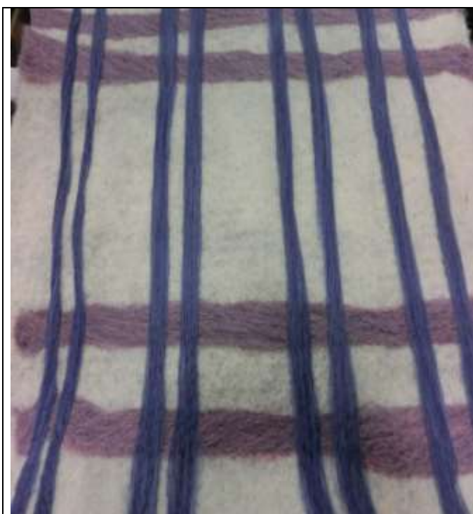
Campione realizzato con agugliatrice manuale: tessuto non tessuto strutturato con filati e stoppini di fibre colorate
