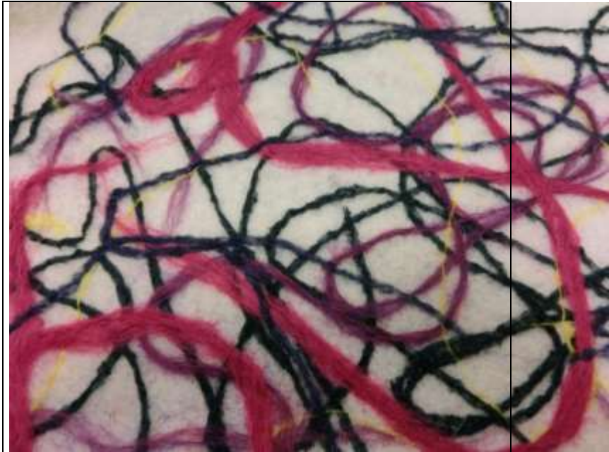
Campione realizzato con agugliatrice manuale: tessuto non tessuto strutturato con filati e stoppini di fibre colorate
