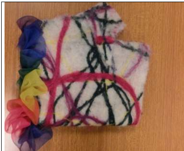
Campione realizzato con agugliatrice manuale: prototipo di guanto realizzato con tessuto non tessuto e tulle
