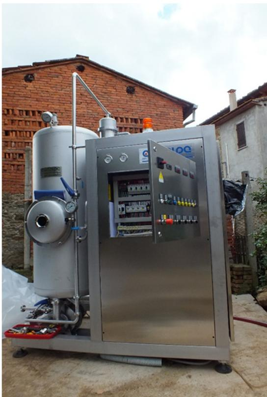
Figura 11 - Concentratore termico sottovuoto utilizzato per ottenere i mosti concentrati
