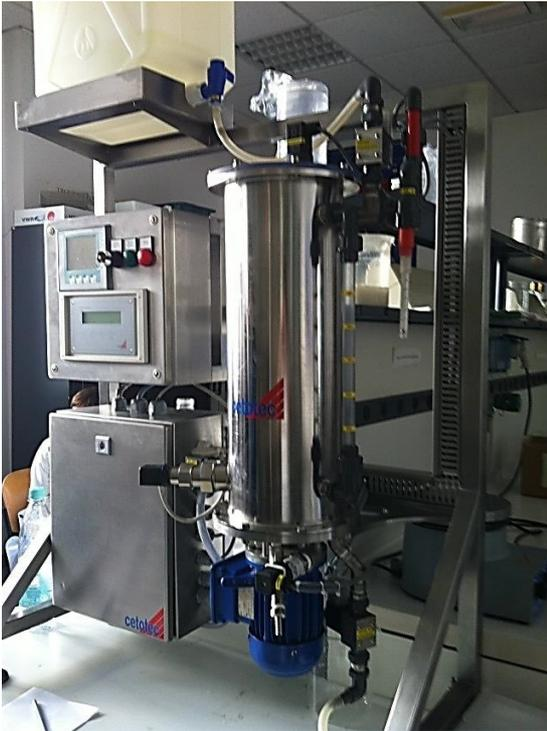
Figura 21 - Fermentatore pilota CETOTEC® impiegato per la preparazione della coltura starter in sistema sommerso
