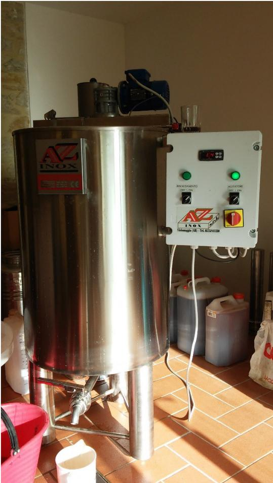
Figura 13 – Riscaldatore utilizzato per la cottura del mosto concentrato
