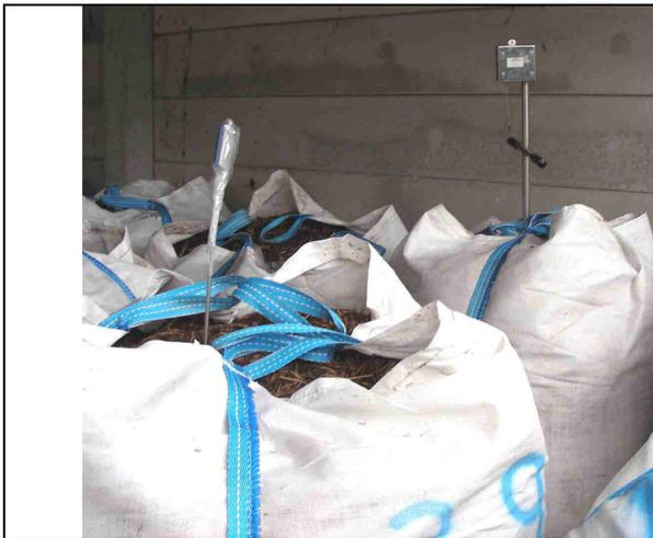
Figura 5. Monitoraggio temperatura massa
