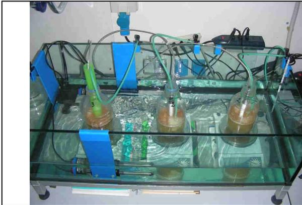
Figura 9. apparecchiatura per misura SOUR
