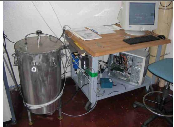
Figura 10. apparecchiatura per misura IRDP
