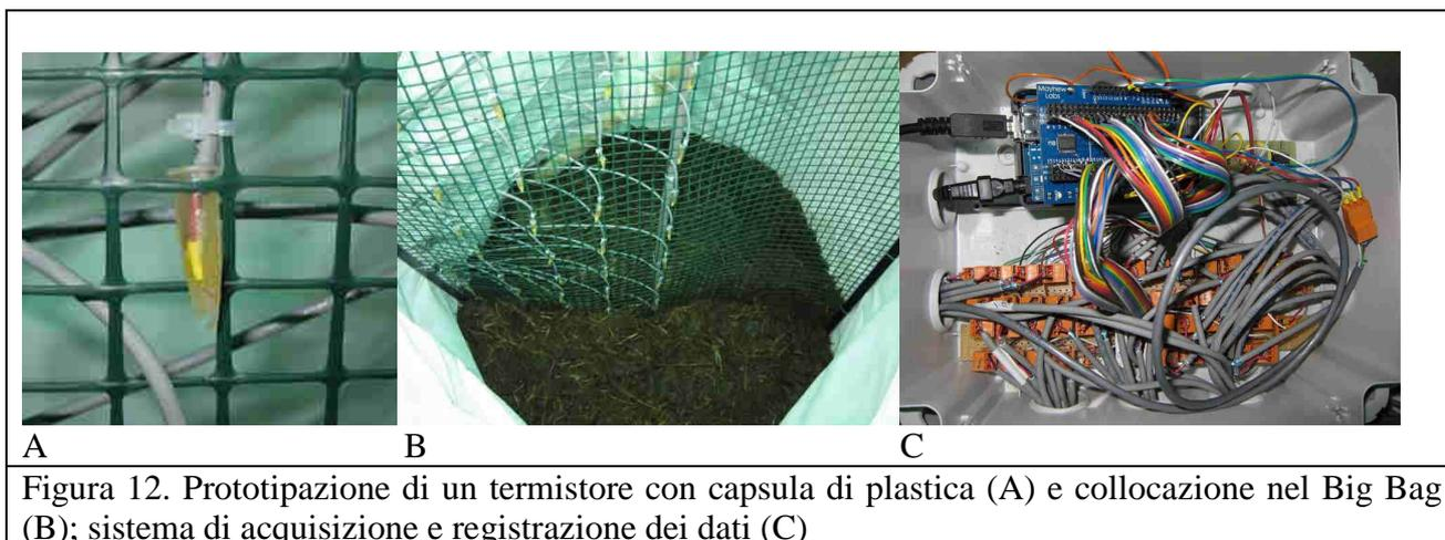
Figura 12. Prototipazione di un termistore con capsula di plastica (A) e collocazione nel Big Bag (B); sistema di acquisizione e registrazione dei dati (C)
