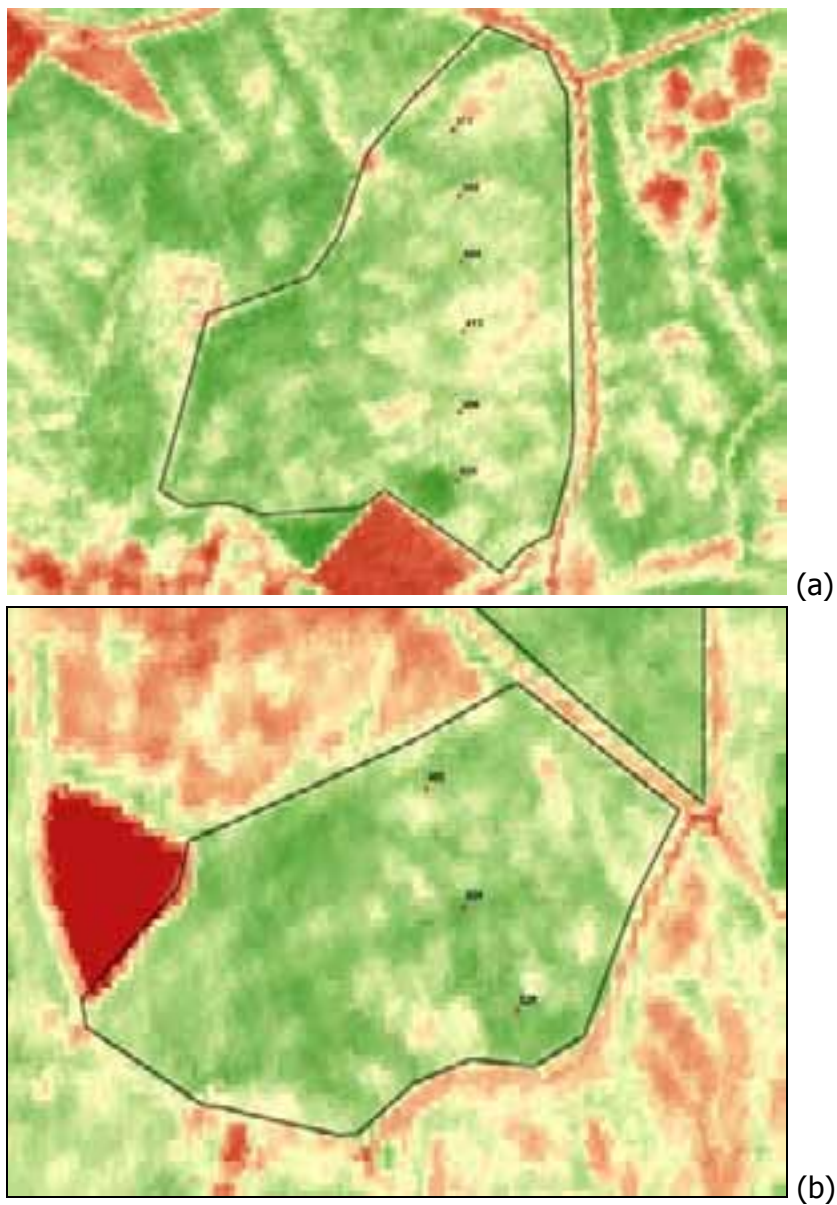
Figura 20 – Esempio di stima del contenuto di azoto nella vegetazione (centigrammi a m^2 ), effettuato nei punti di campionamento/verifica, parcelle Nardi (a) e Di Donato (b).
