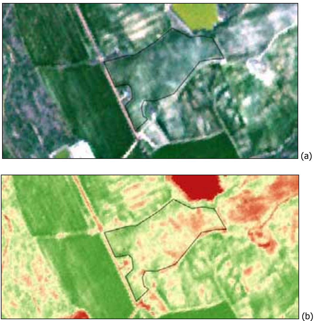
Figura 18 - Immagine del 12 Aprile 2012 dal satellite Rapid Eye sul visibile (RGB) (a) e dell'indice di vegetazione NDVI (b), parcelle Rappuoli.
