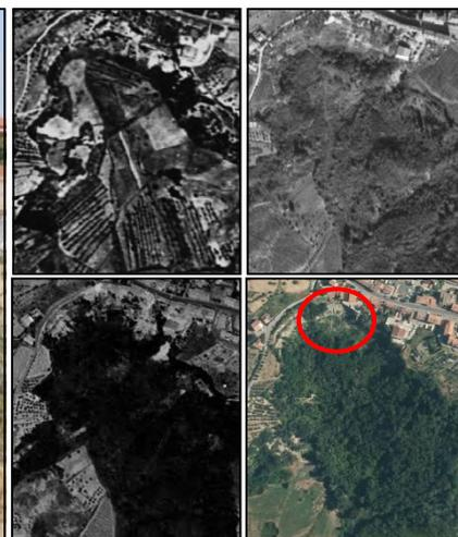
*Fig.26 – Particolare della frana 14, Montespertoli: si evidenzia il settore danneggiato dall'arretramento della scarpata.*
