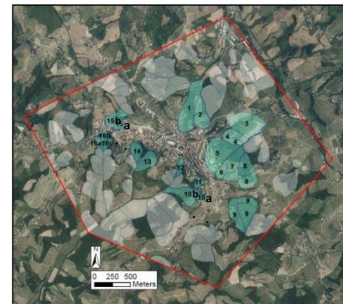
Fig. 22 - Schema generale delle frane cartografate sul territorio di Montespertoli: le frane numerate sono state oggetto di analisi multi-temporale.
