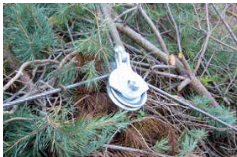
Carrucola per la deviazione del percorso di concentramento
