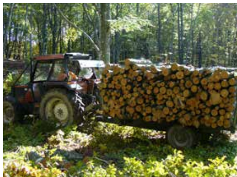
Img. 84 Trattore a doppia trazione con rimorchio a ruote motrici
