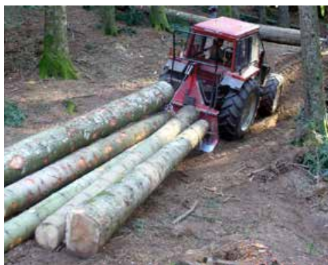
Esbosco a strascico con trattore
