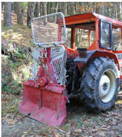
Verricello portato sul sollevatore idraulico di un trattore
