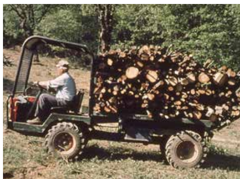
Img. 85 Piccolo trattore portante, transporter, nell'esbosco di legna da ardere
