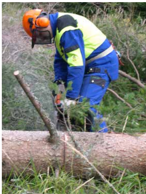
Rilascio di un ramo per la rotazione del toppe
