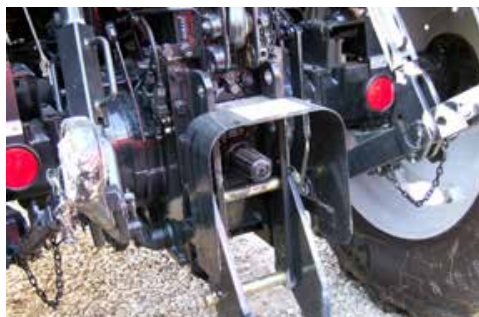
Protezione dell'albero scanalato della presa di potenza
