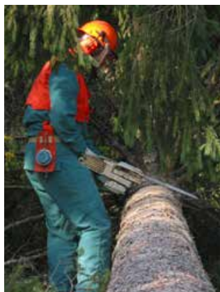
Img. 17 Corretta sramatura con motosega appoggiata al fusto
