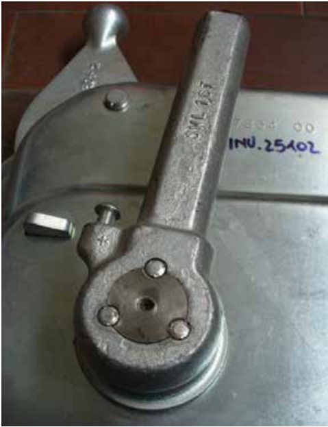
img. 34 Particolare delle spine di sicurezza di un paranco
