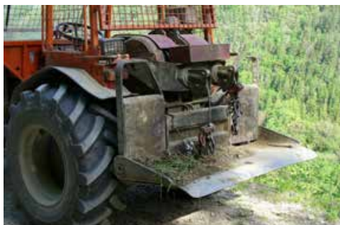
Verricello montato fisso sul trattore
