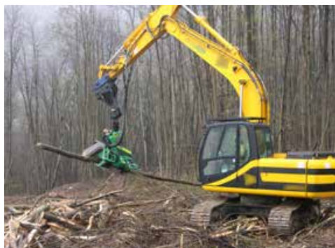
Testa harvester su macchina movimento terra
