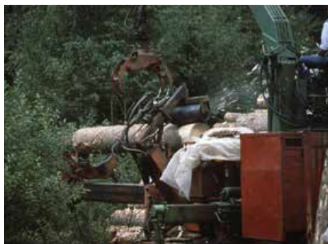
Scortecciatura con macchina scortecciatrice
