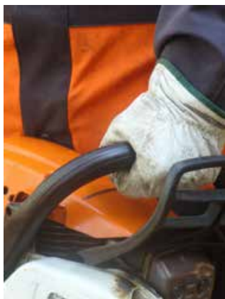
Img. 16 Corretta impugnatura della motosega con il pollice chiuso
