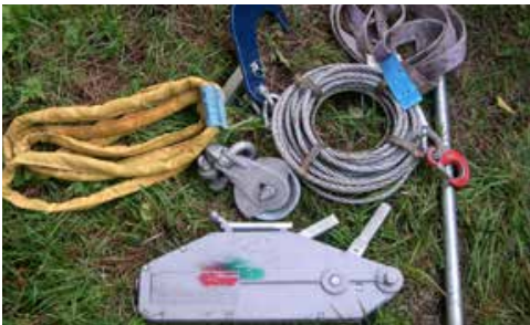
Img. 33 Paranco manuale con i necessari accessori
