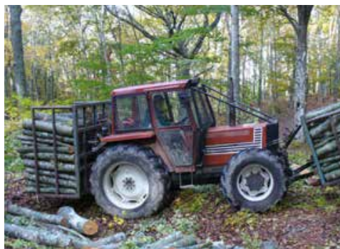
Esbosco con trattore allestito con gabbie
