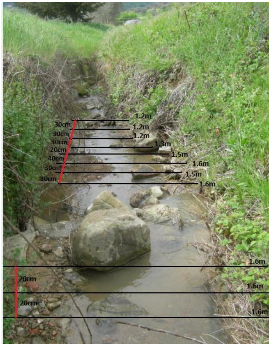
Fig. 2.94 - Schema degli stendimenti effettuati sul sito del campionamento Ra2
