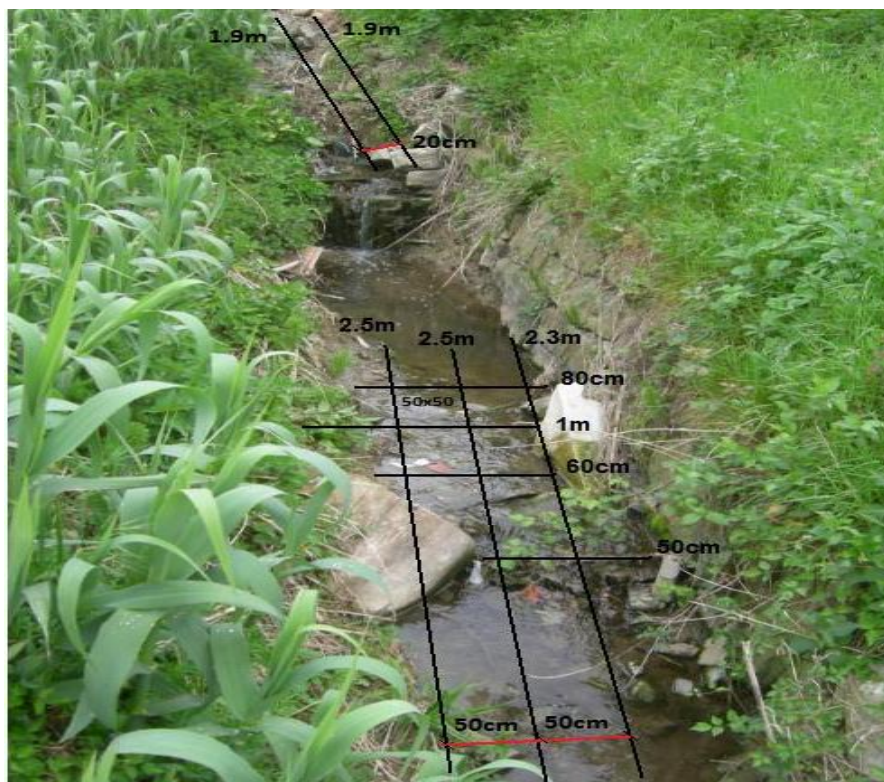
Fig. 2.48 - Schema degli stendimenti effettuati sul sito del campionamento An2.
