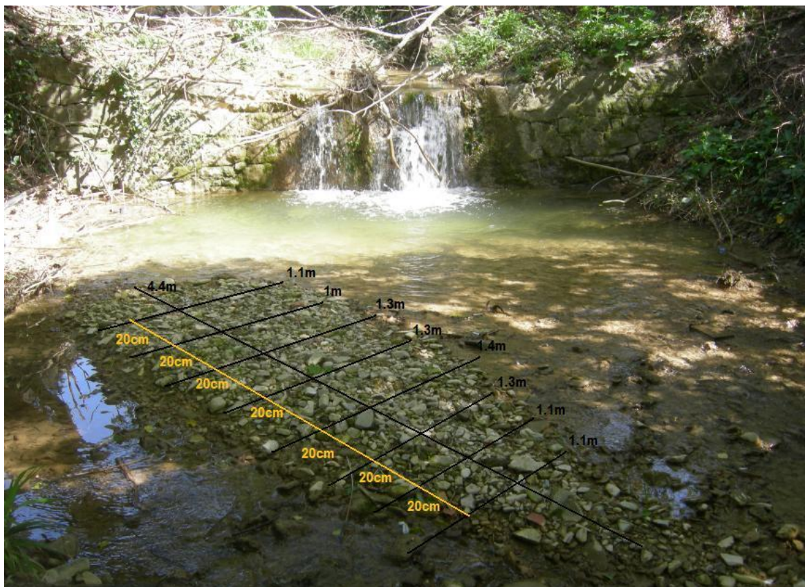
Fig. 2.78 - Schema degli stendimenti effettuati sul sito del campionamento Pe1.
