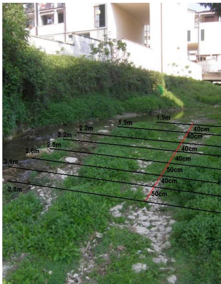
Fig. 2.99 - Schema degli stendimenti effettuati sul sito del campionamento Sa1.
