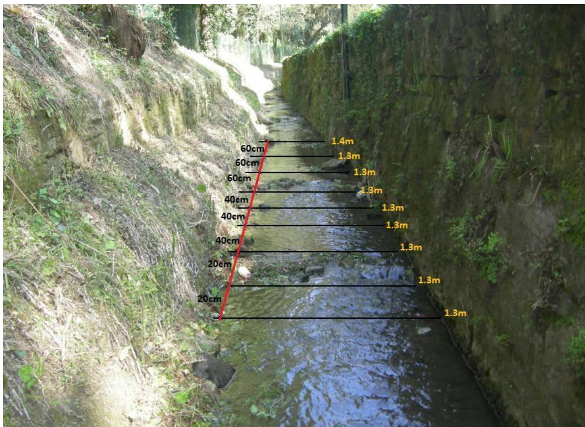
Fig. 2.38 - Schema degli stendimenti effettuati sul sito del campionamento Af1.
