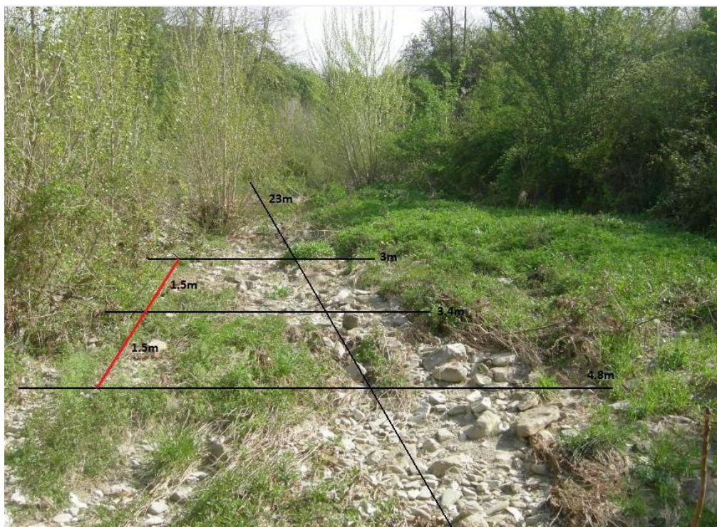
Fig. 2.73 - Schema degli stendimenti effettuati sul sito del campionamento Mu2.
