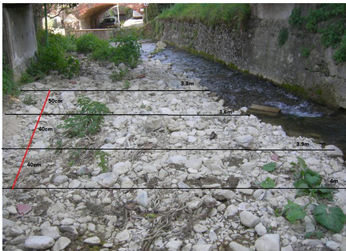
Fig. 2.53 - Schema degli stendimenti effettuati sul sito del campionamento Fa1.
