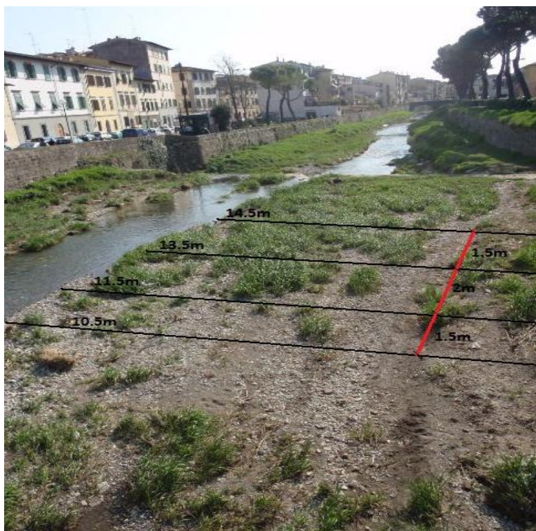
Fig. 2.68 - Schema degli stendimenti effettuati sul sito del campionamento Mu1
