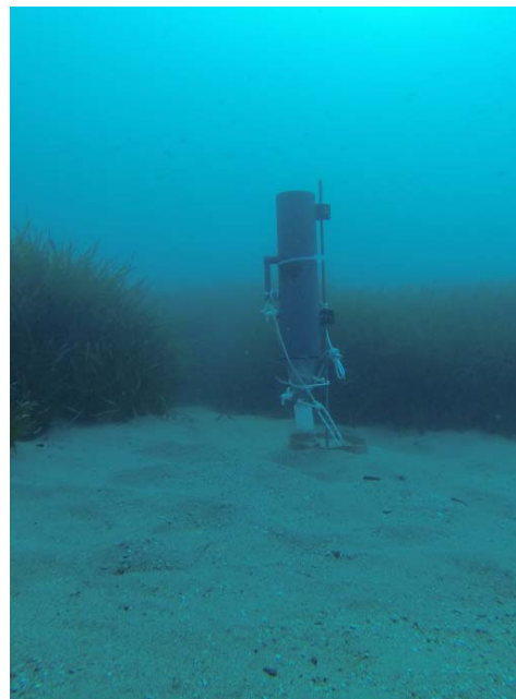
La trappola denominata B (a sinistra) e la F (a destra), operative sul fondale
