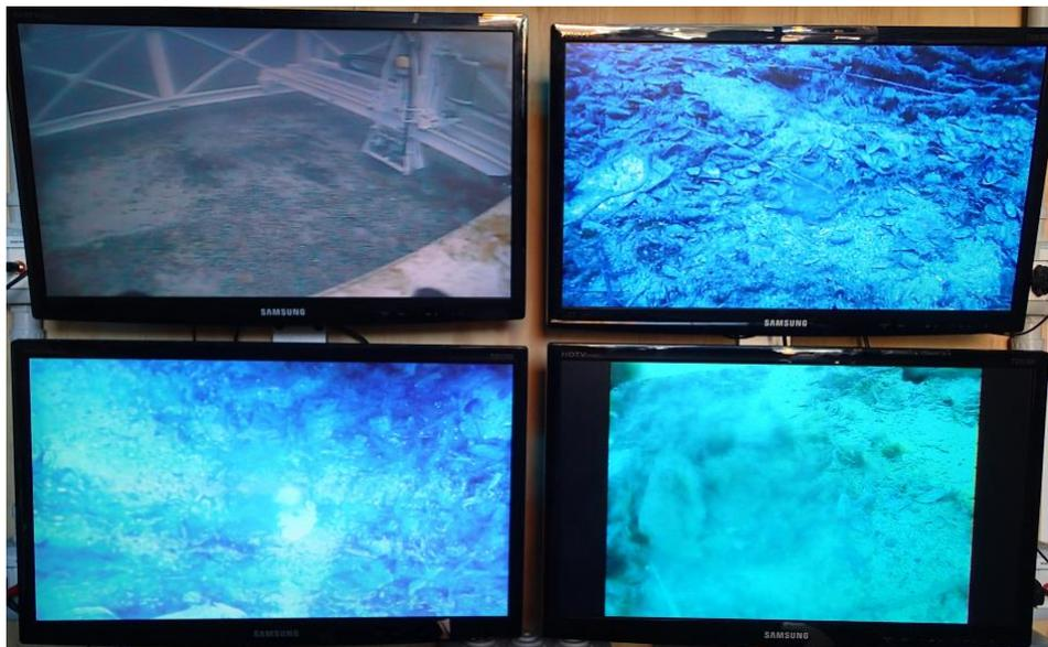
I monitor a bordo della sala controllo delle operazioni: in alto a sinistra il ROV riprende l'intera operazione ed è visibile la struttura sommersa, a destra il campo inquadrato davanti alla sorbona con il fondale da ripulire, in basso a sinistra il campo inquadrato dopo il passaggio della sorbona, a destra l'immagine proveniente dalla telecamera della sorbona mentre si aspira.
