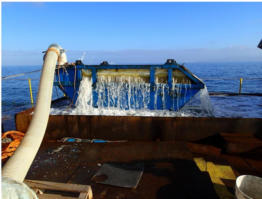
Il tubo di aspirazione che porta il materiale raccolto nel cassone in superficie. L'acqua che fuoriesce appare pulita e senza sedimento fine
