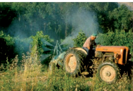
vecchia irroratrice senza ventilatore
