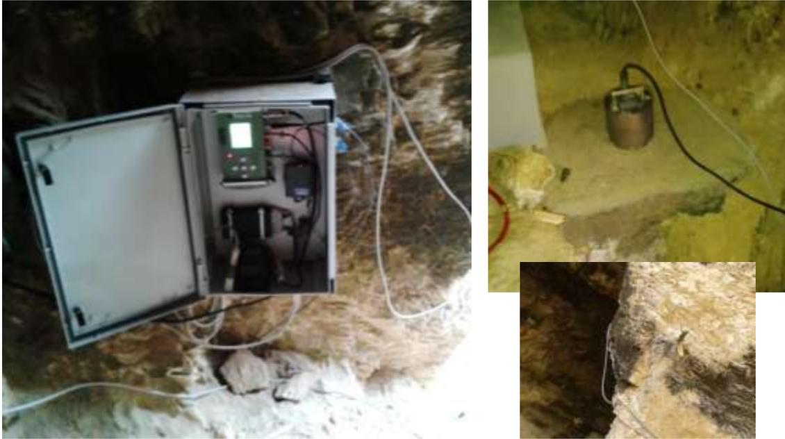
**Figura 14: Stazione EQUI – particolare relativo al box contenente l’acquisitore Taurus, l’alimentatore e gli apparati di protezione, il modem GPRS/UMTS UR5, al sensore sismico Guralp CMG40 (su basamento in cemento armato), e il modem di controllo Nethix e all’antenna di trasmissione del modem GPRS/UMTS UR5.**
