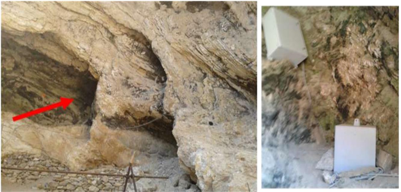
**Figura 13: Stazione EQUI – sito di installazione ed alloggiamento della strumentazione (sono visibili in figura, il box contenente le batterie tampone e la struttura di copertura del sensore)**
