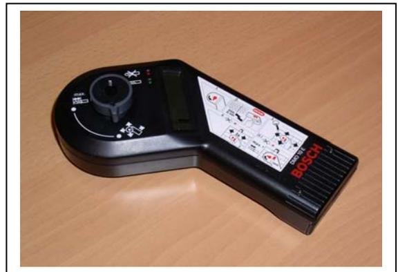
Foto2. Strumento per l'individuazione armature
