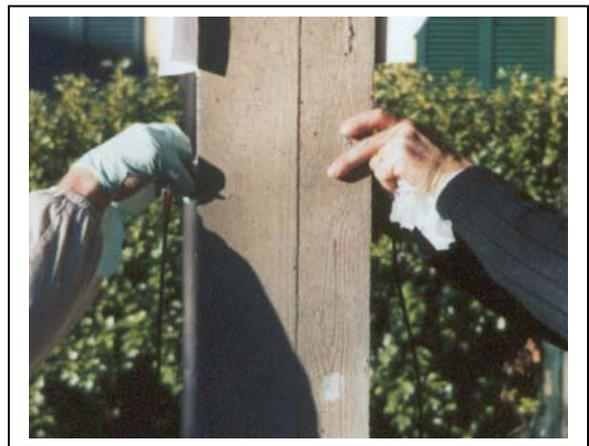
Foto 13. Corretto allineamento delle sonde
