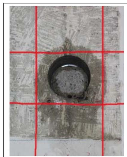
Foto 15. Armature rilevate e carota
