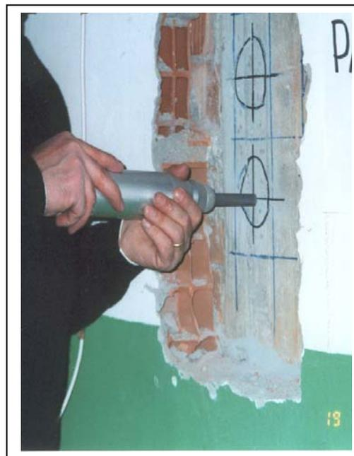
Foto 11. Prova sclerometrica
