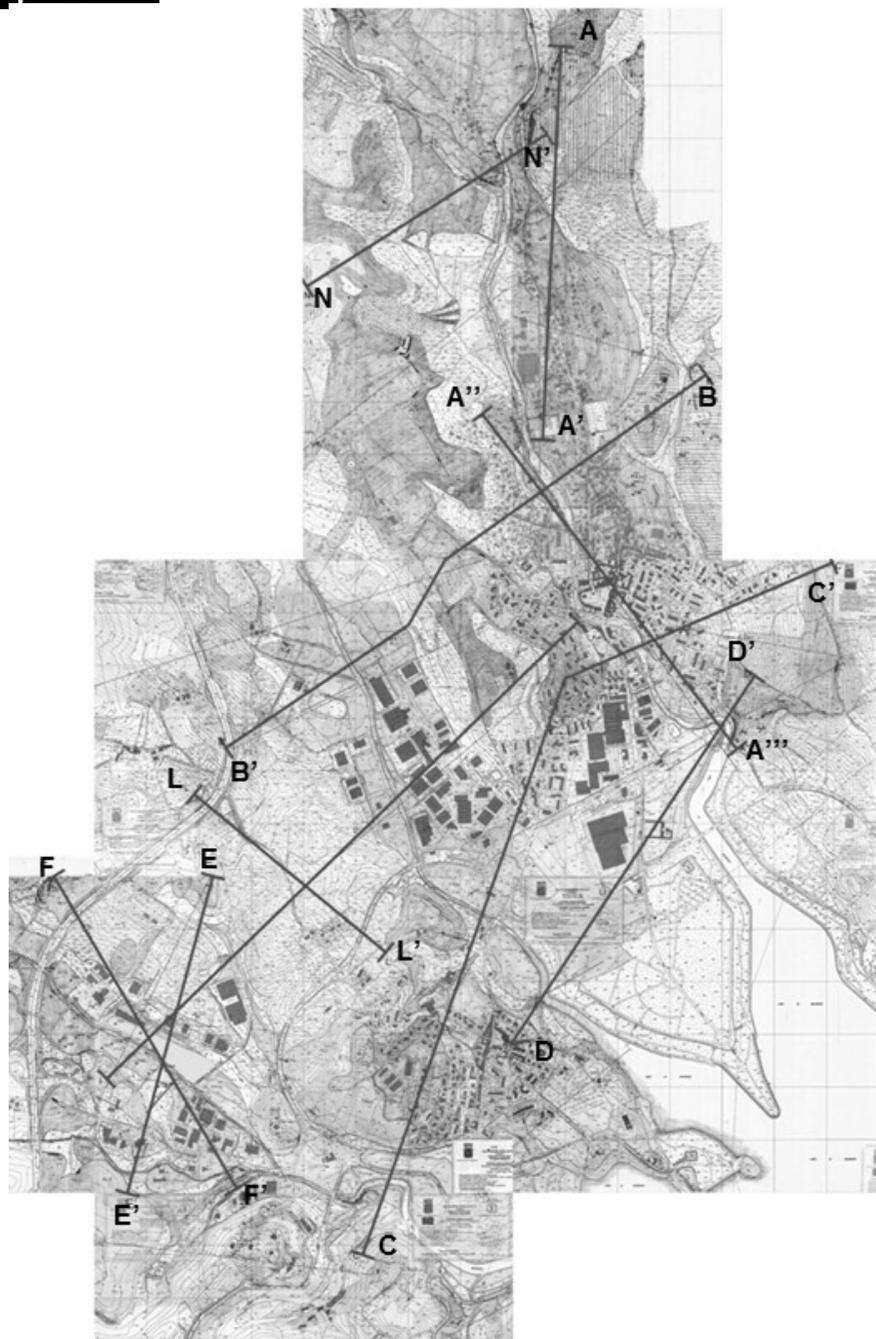
Carta geologica dell'area di Barberino di Mugello (Capoluogo) con ubicazione delle indagini (stese sismiche e sondaggi) e tracce delle sezioni
