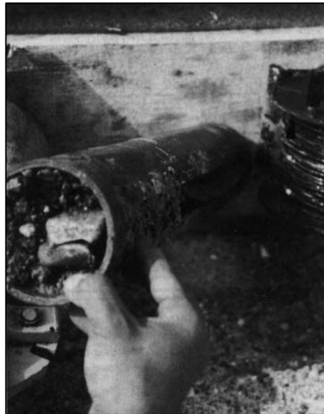
Figura 3B21 – Prova LPT, esempio di campione estratto (Rodio, Stretto di Messina, 1988). Da Cestari, 1990
