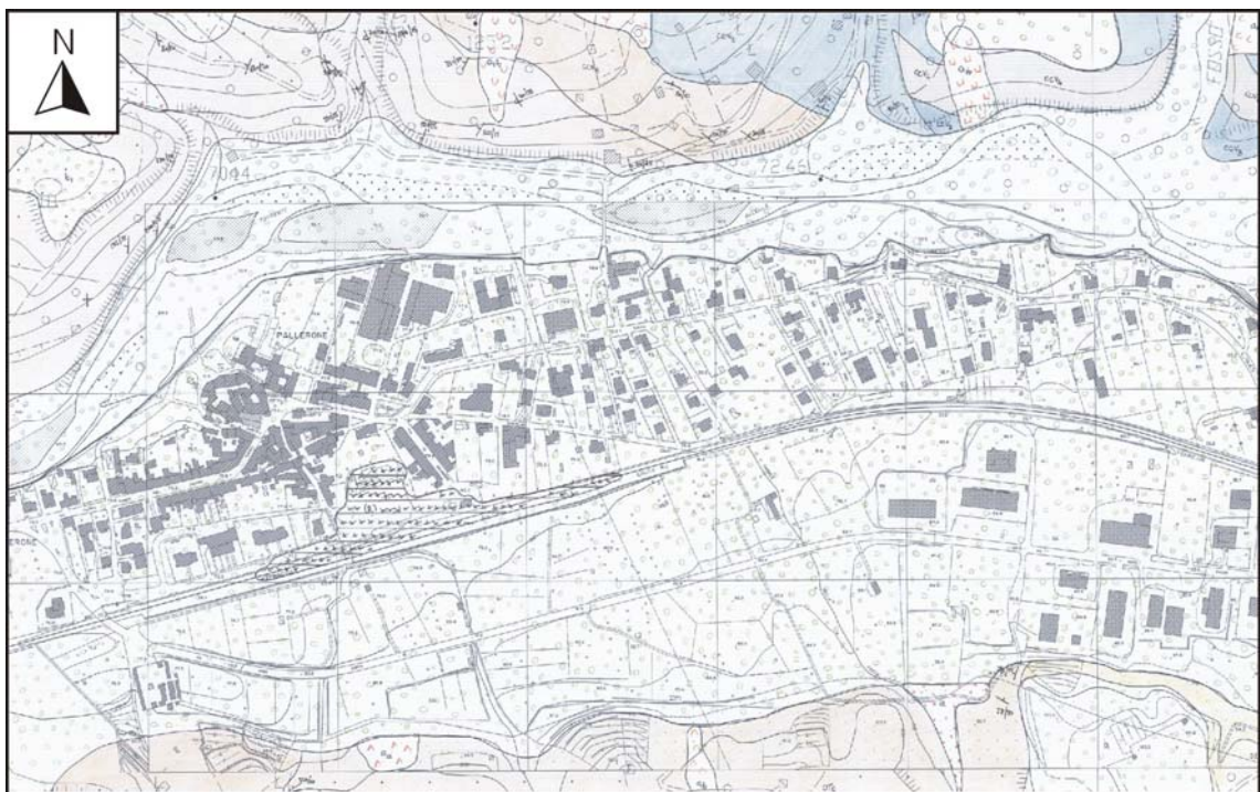
Figura 1B7 – Esempio di carta geomorfologica realizzata nell’ambito del Progetto VEL da rilievo in scala 1:2000 (ai fini della rappresentazione nel presente documento la scala è stata ridotta). Le relative legende sono dettagliatamente riportate nei seguenti Volumi: Lunigiana e Garfagnana (Volume n. 2), Valtiberina (Volume n. 3), Casentino (Volume n. 4), Mugello (Volume n. 5), Amiata (Volume n. 6).
