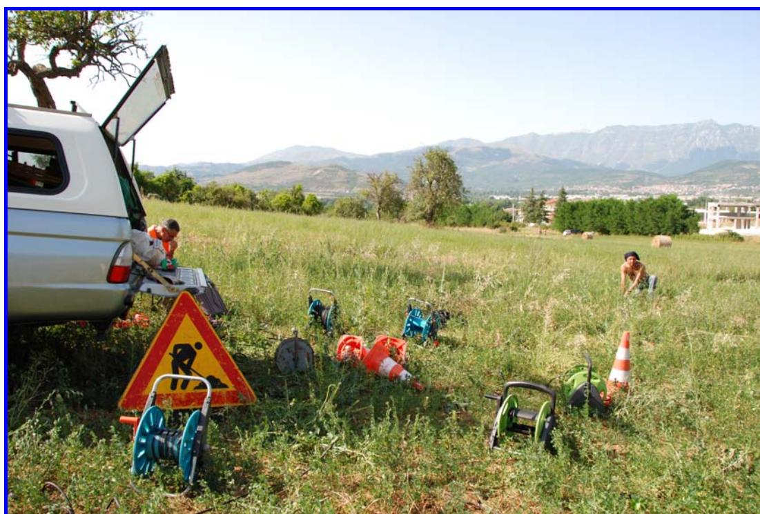
Profilo OCR3b (Cavalletto) – Sito di indagine durante l'allestimento della linea sismica
