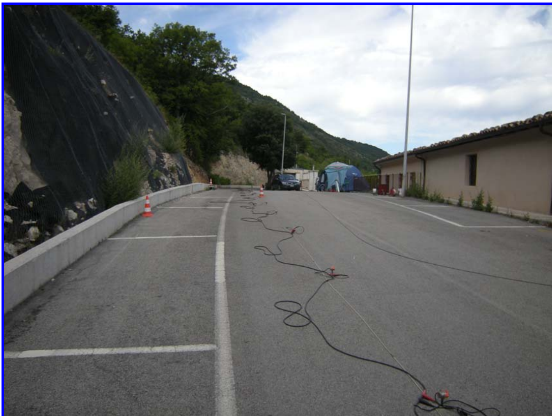
Profilo PIA2 (Pianola) – Panoramica dello stendimento con geofoni 10 Hz con dx = 3\text{ m} durante le acquisizioni con le onde SH
