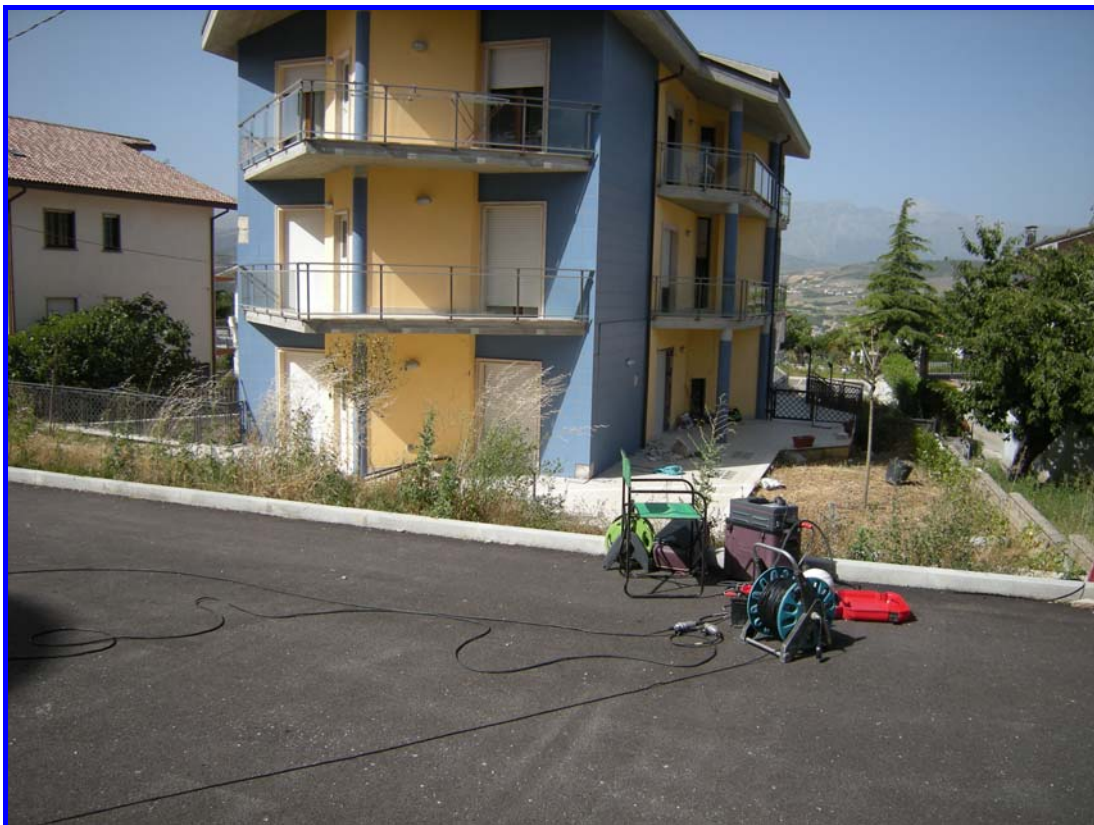
Profilo PIA5 (Pianola) – Sito di indagine con il sismografo Geometrics Stratavisor NZXP usato per le registrazioni
