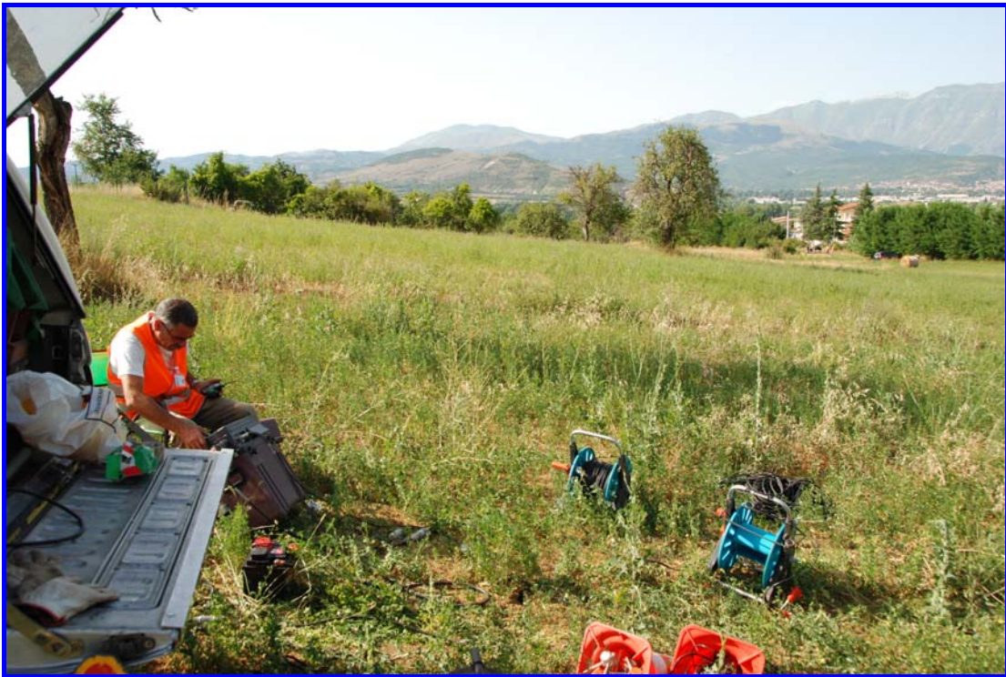
Profilo OCR3b (Cavalletto) – Sismografo Geometrics Stratavisor NZXP usato per le registrazioni sismiche
