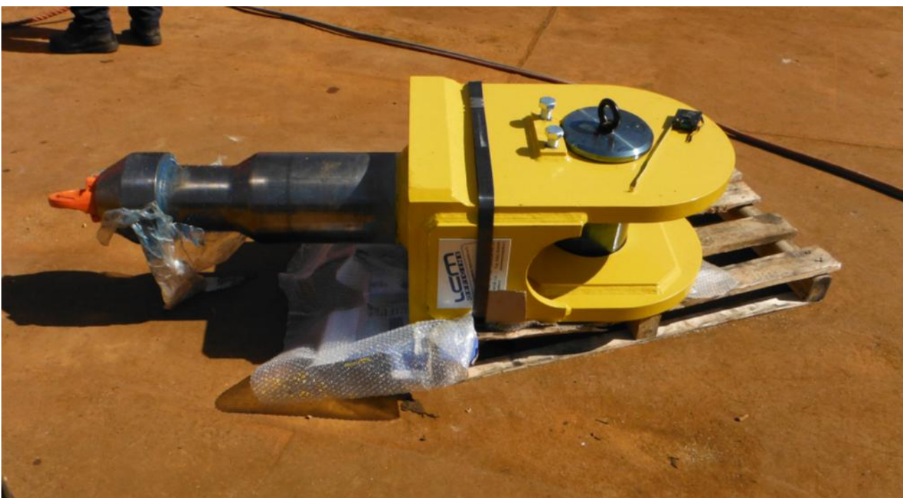
Sopra: installazione "link plates" sul cassone S11 presso il cantiere di Livorno Sotto: "swivel pin" da collegare alle catene in preparazione al rigalleggiamento
