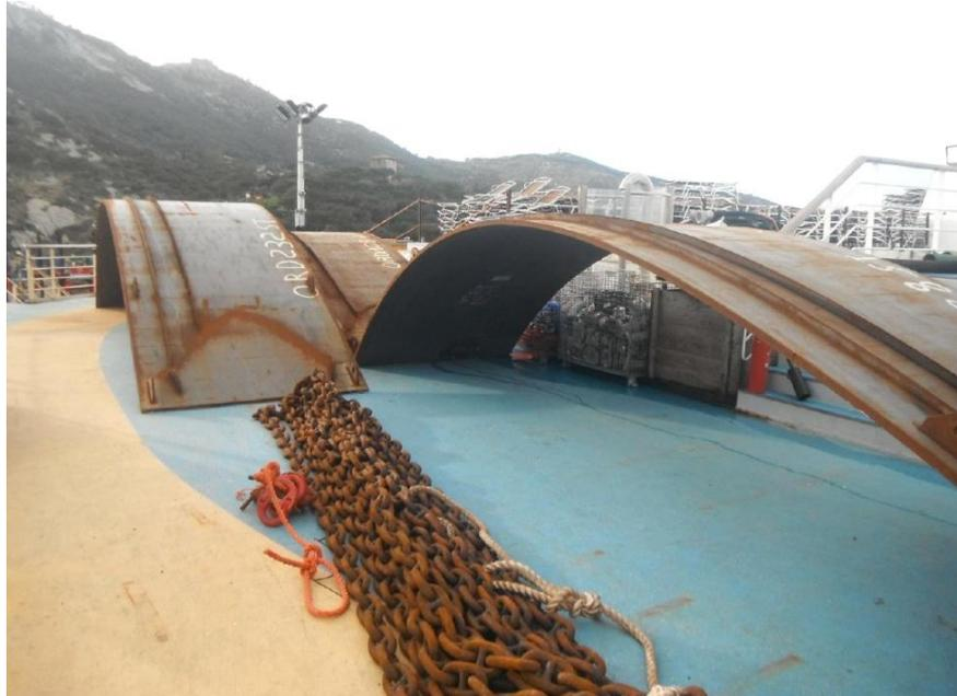
*Rinforzi del ginocchio (Bilge Plates) da installare sul lato destro della nave per il passaggio delle catene*
