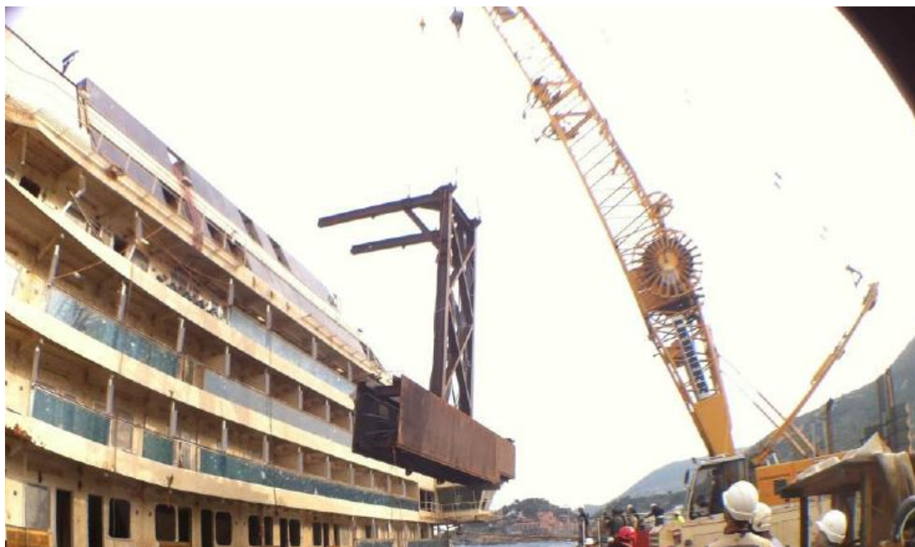
Sopra: Installazione del bumper di pruvavia sulla fiancata di dritta per la successiva installazione del cassone S3
